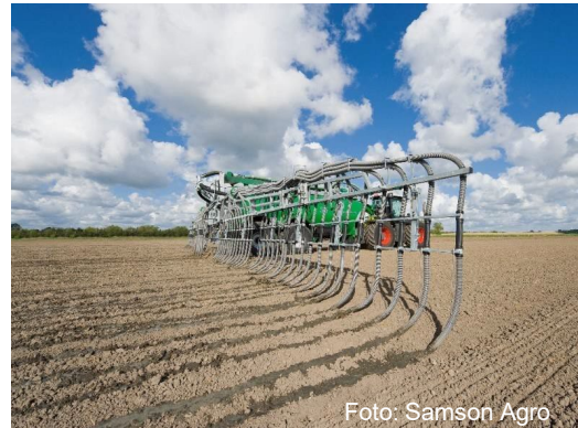
Udlægning med slæbeslanger
